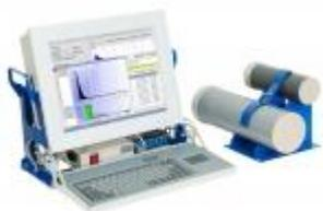
Установка предназначена для гамма-съемки местности и обычно включается в состав передвижной радиологической лаборатории.
