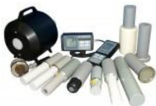
Дозиметр-радиометр МКС-АТ1117М представляет собой многофункциональное носимое средство измерения с цифровой индикацией показаний, включающее в себя блок обработки и индикации информации (БОИ или БОИ2) со встроенным газоразрядным счетчиком и внешние интеллектуальные блоки детектирования различного назначения.
