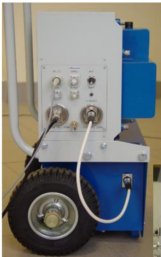
Установка комплектуется интерфейсом RS-232 и интерфейсами Ethernet IEEE 802.3 и RS-485. RS-232 является служебным интерфейсом для управления, диагностики, настройки и ремонта с помощью программы «Конфигуратор», а RS-485 и Ethernet IEEE 802.3 внешними интерфейсами для включения установки в системы радиационного контроля. Устройство, подключенное к выходу «сухой контакт», может быть включено/выключено при превышении уставки.
