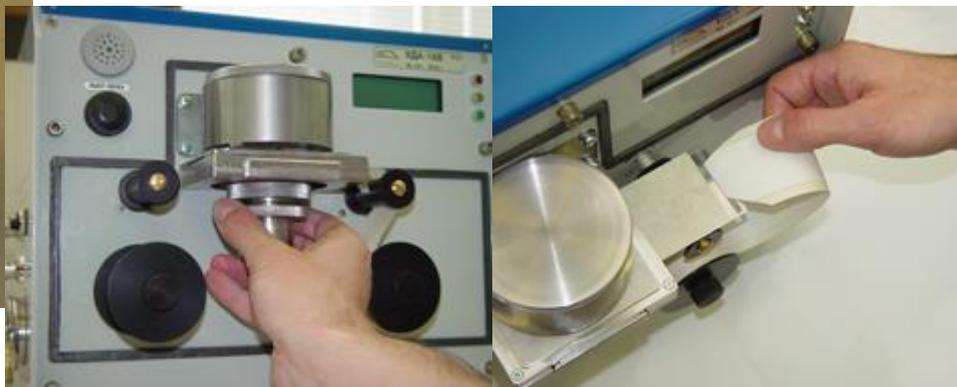
Новый кадр ленты фильтра устанавливается после каждого включения установки или перезагрузки управляющей программы установки. При работе установки новый кадр устанавливается по мере запыленности ленты (по уменьшению расхода и в соответствии с показаниями дифференциального манометра о перепаде давления до и после ленты) и по мере накопления активности на ленте.
