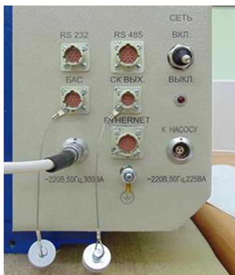
Установка комплектуется интерфейсом RS-232 и интерфейсами Ethernet IEEE 802.3 и RS-485. RS-232 является служебным интерфейсом для управления, диагностики, настройки и ремонта с помощью программы «Конфигуратор», а RS-485 и Ethernet IEEE 802.3 внешними интерфейсами для включения установки в системы радиационного контроля. Устройство, подключенное к выходу «сухой контакт», может быть включено/выключено при превышении уставки.
