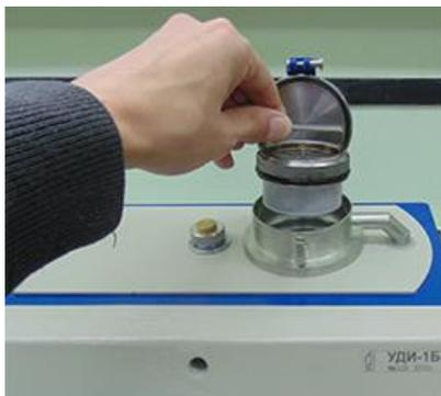
В держателе установлена кассета с сорбентом из сорбционно-фильтрующего материала. Замена кассеты с сорбентом производится при появлении сообщений о загрязнении сорбента, о чем установка выдает сообщение на ЖКИ и в информационную сеть.
