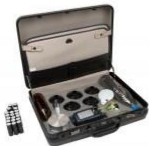
Комплект оборудования на основе угольных адсорберов для комплексных измерений объемной активности радона. Удобен при проведении массовых обследований по определению среднегодовых объемных активностей радона (ОАР) в жилых и производственных помещениях.
