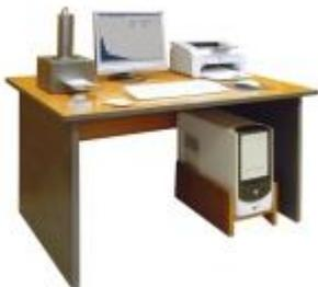
Прибор для измерения содержания стронция-90 в продуктах питания, др. пробах органического происхождения, в воде и в почве, пробах, полученных радиохимическим выделением, определения суммарной бета-активности проб воды.
